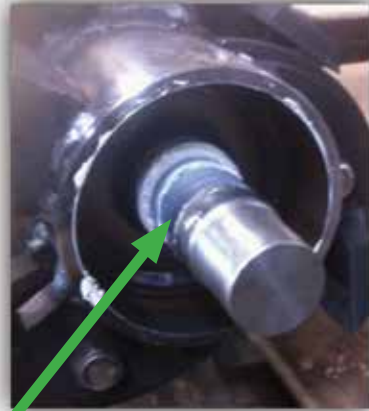
Arbre du rotor en contact avec l'assemblage et imprégné de la pâte de montage
