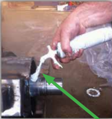
Arbre du rotor en contact avec l'assemblage et imprégné de la pâte de montage
