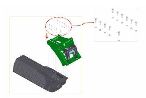
Le pied d'appui est prévu pour un montage avec un broyeur SEVE (livré en option). Nous contacter pour l'utilisation d'une autre marque.
